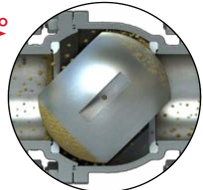
La gran superficie esférica permite que se acumule producto en la superficie de la bola y en la cavidad de la bola aguas abajo.
