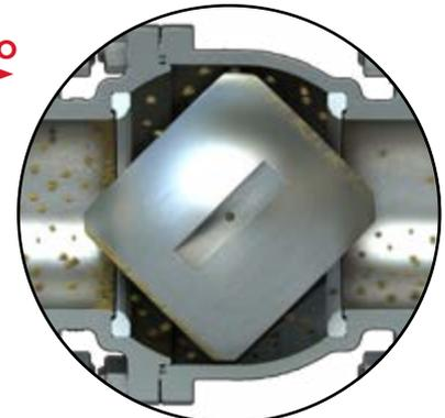
El diseño de bola modificado minimiza los efectos de la acumulación de producto en la superficie del sello de la bola y permite que las partículas fluyan a través de la cavidad del cuerpo cuando se abre.
