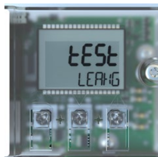
Prueba de Fugas Iniciada
