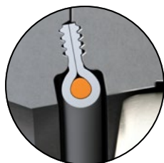
Disque en Position Ouverte. Siège non comprimé.
