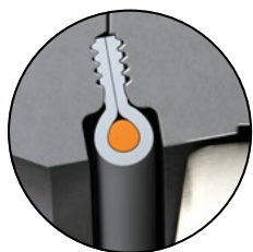
Disque en Position Ouverte. Siège non comprimé.
