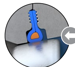
Disque en Position Fermée. Pression dans le sens d'écoulement non-préférentiel .
