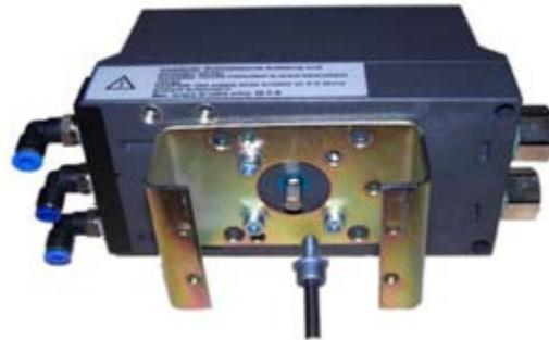
**Etapa 2** Posicione o eixo de saída do posicionador de forma que a parte plana (1) fique voltada para cima.
