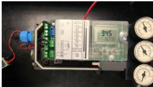
**Etapa 23** Após a conclusão da calibração, insira uma chave de fenda de 4 mm de largura na ranhura localizada sob a roda de ajuste e gire a roda para a esquerda até sentir que ela se encaixa. Isso ajuda a evitar que a roda da embreagem deslize durante a atuação.
