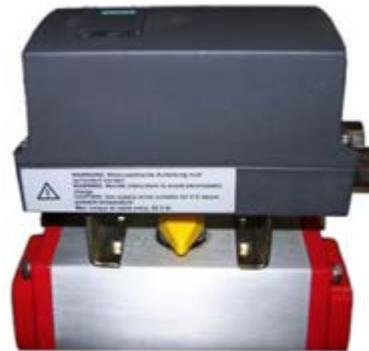
**Etapa 6** Insira as conexões pneumáticas no posicionador e no atuador antes de inserir a tubulação nas saídas do posicionador para as entradas do atuador.
