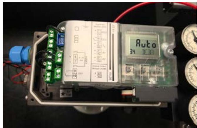
**Etapa 7** Aumente a banda morta para reduzir a oscilação desnecessária da válvula pressionando o Botão Para Cima.
