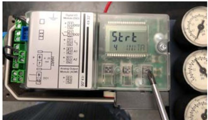
**Etapa 17** Observação: Se for exibido um erro no seu posicionador durante a Execução 2, a tolerância inferior (tolerância baixa) da roda de ajuste foi excedida. (Se nenhum erro for exibido, pule para a etapa 18.)
