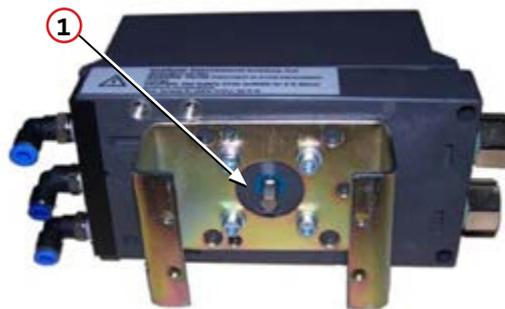
**Etapa 3** Insira o acoplador sobre o eixo de saída. Assegure o alinhamento adequado do parafuso de fixação do acoplador com o lado plano do eixo antes de apertar o parafuso de fixação.
