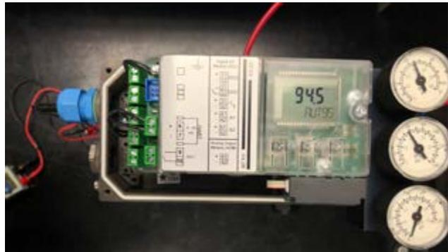
**步骤 23** 校准完成之后, 将 4 mm 宽的螺丝刀插入位于调整轮下方的插槽中, 然后向左转动调整轮, 直到感觉到其已卡入。这有助于防止离合器轮在工作过程中滑移。
