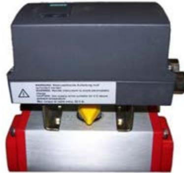
**步骤 6** 将气管接头拧入定位器和执行机构，然后将导管插入定位器的出口和执行机构的入口。
