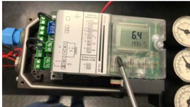
**步骤 22** 步骤 12: 在“AUTO”(自动)模式下, 通过改变 4-20mA 控制信号, 测试设备响应。
