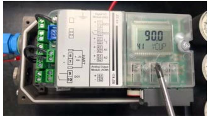
**步骤 14** 使用菜单按钮
