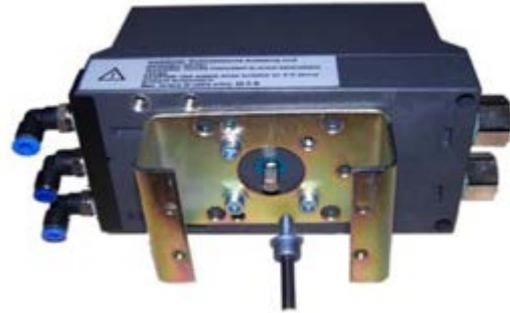
**步骤 2** 安装定位器的输出轴，确保平坦 (1) 一端朝上。
