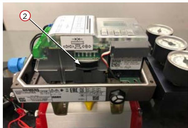
**步骤 8** 使用 4 mm 宽的螺丝刀，将端子底部的黄色离合器轮 (3) 调整至 90° 位置。
