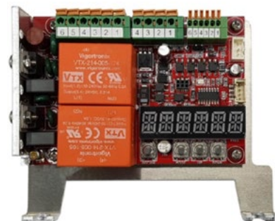
Figura 12: Tarjeta de Control Modulante de 24V CC
