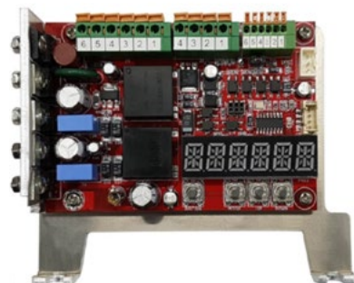
Figura 12: Tarjeta de Control Modulante de 24V CC
