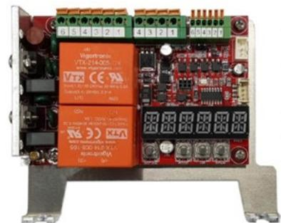
**Figura 13:** Tarjeta de Control Modulante de 24V CC
