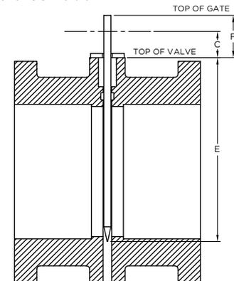
**Figura 15:** Ajuste de carrera, válvula abierta
