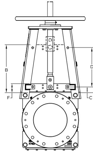
**Figura 14:** Ajuste de carrera, válvula cerrada
