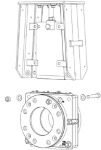
**Figura 9:** Extracción de la Compuerta
