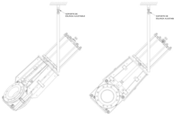
Figura 5: Válvula con Actuador a 45°
