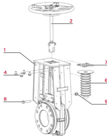
**Figura 12:** Conversión del Actuador Neumático
