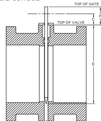
**Figura 15:** Ajuste de carrera, válvula abierta
