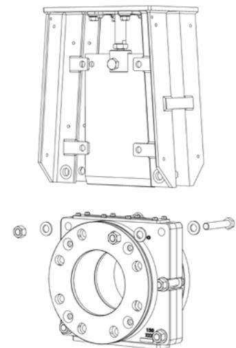
**Figura 9:** Extracción de la Compuerta
