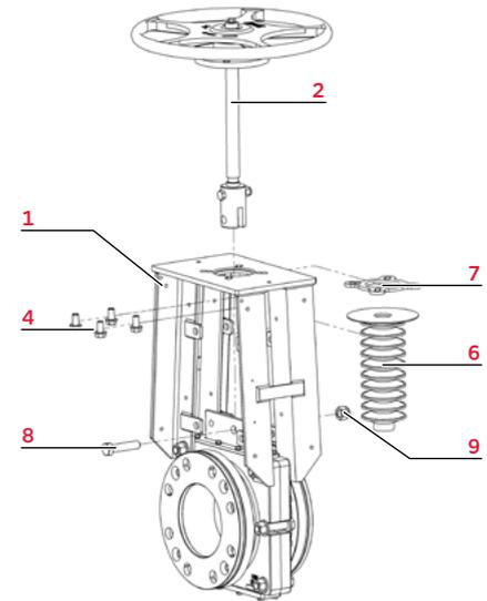
**Figura 12:** Conversión del Actuador Neumático
