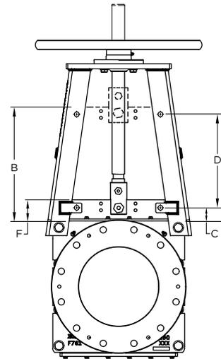
**Figura 14:** Ajuste de carrera, válvula cerrada
