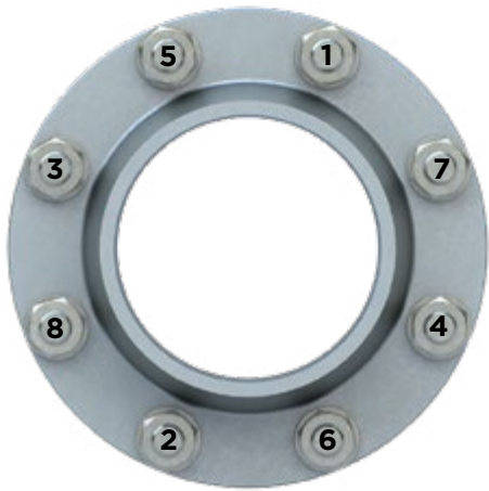
Figura 2: Patrón de Ajuste del Perno de la Brida
