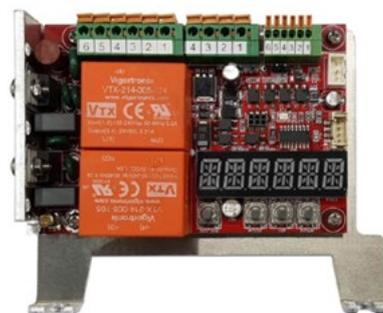
Figura 13: Placa de Controle de Modulação 24V CC
