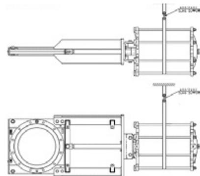
**Figura 5:** Válvula com atuador a 45°
