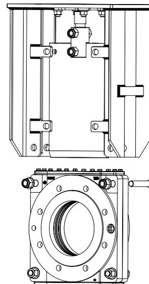
**Figura 8:** Remoção da Faca
