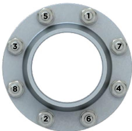
**Figure 3 - Centralização Inicial e Flange da Válvula**
