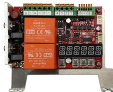
**Figure 12:** Carte du Contrôleur Modulant 24V CC
