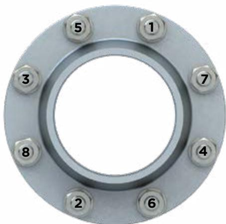
**Figure 3 - Centrage Initial et Réglage des Brides**
