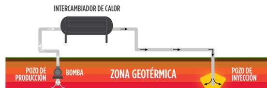
En un sistema de diseño binario, las válvulas Tri Lok son utilizadas para controlar el flujo de salmuera caliente desde el pozo hacia el intercambiador de calor y en la salida del intercambiador de calor controlando el flujo al pozo de inyección.
