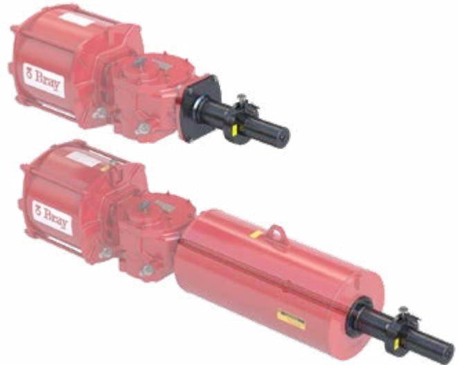
**Amortiguador hidráulico:** La opción de actuador yugo escocés de la Serie 98 proporciona una amortiguación ajustable antes de que la válvula cierre, lo que evita que se cierre de golpe, se dañe el asiento de la misma, y se produzcan vibraciones y golpes en la tubería.
