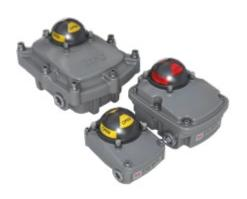
5A、5B 和 5C 系列阀门状态监测器(VSM)可在任何符合 VDI/VDE 3845 标准的角行程执行机构上提供位置的视觉和电气指示。 VSM 可安装在垂直和平行方向上,无需更换支架。 可用于常规用途(5A 和 5B 系列)或危险场所(5C 系列为防爆型,5A/B 系列为本安型)。
