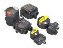
54系列接近传感器可为角行程阀提供位置指示。采用卓越设计,可为 工厂高效运行提供持久可靠的阀门监测和控制方案。54系列外形紧 凑,可直接安装到符合 VDI/VDE 3845 标准的执行机构上,实现更小且 节省成本的执行机构外形。各种电力输出选项可将54系列集成到所有 标准的工艺控制环境中。
