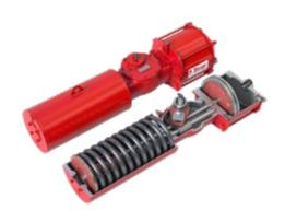
98系列拨叉式执行机构采用模块化设计,配有各种不同的模块,以适应所需的工艺应用。98系列的核心是拨叉(对称型或斜型),可将线性运动转换为旋转运动。
