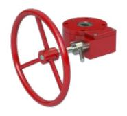
此操作机构非常适合用于弹簧复位执行机构的安全运转。 在气动操作期间,齿轮装置的蜗杆脱离。如果在断电情况下阀门需要打 开或关闭,则手动旋转离合器操纵杆可进行凸轮操作并将蜗杆与分段蜗 轮啮合,从而可使用手轮来旋转阀门。
