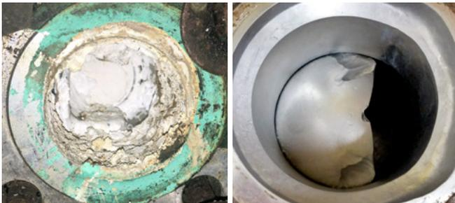
**DESAFÍOS:** Las válvulas típicas muestran una acumulación extrema de sólidos o una erosión acelerada después de pocos meses de servicio en aplicaciones duras de procesamiento de azúcar.
