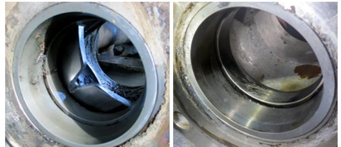
**SOLUCIONES:** Las válvulas S19L de Bray no presentan señales de abrasión o erosión después de más de 24 meses de servicio en aplicaciones similares de procesamiento de azúcar.
