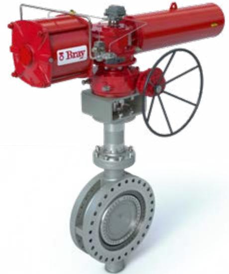
Válvula mariposa de triple excentricidad Tri Lok; actuador neumático yugo escocés S98, amortiguador hidráulico, operación manual por decluchable.
