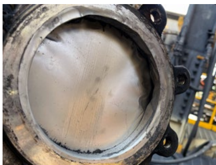
Estas imágenes muestran signos significativos de daño en las válvulas de cuchilla unidireccionales existentes.
