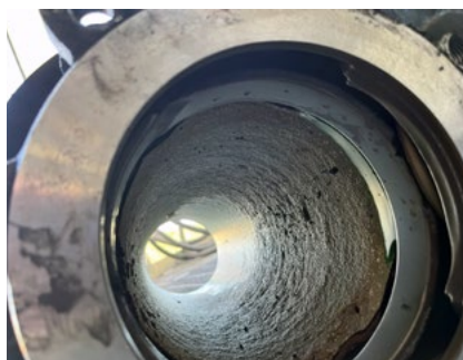
Estas imágenes muestran signos significativos de daño en las válvulas de cuchilla unidireccionales existentes.
