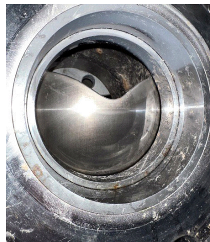
La inspección de la válvula de control fallida de un competidor muestra signos de erosión extensa de la pared, el segmento, el asiento, y el área de brida cuerpo.
