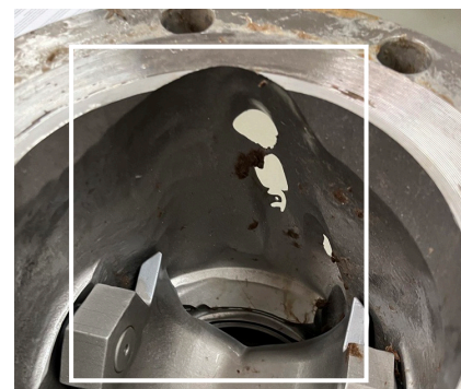
La inspección de la válvula de control fallida de un competidor muestra signos de erosión extensa de la pared, el segmento, el asiento, y el área de brida cuerpo.
