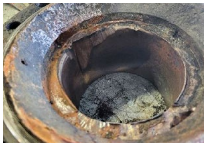
La válvula de bola de la competencia mostró signos de daño severo en la bola (izquierda) y el asiento (derecha) causado por el fluido abrasivo.
