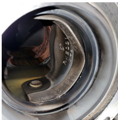
Después de 18 meses de servicio, la válvula de bola segmentada de la Serie 19L de Bray no mostró signos de desgaste o daño.
