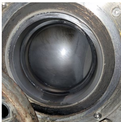
Después de 18 meses de servicio, la válvula de bola segmentada de la Serie 19L de Bray no mostró signos de desgaste o daño.
