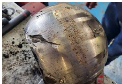
La válvula de bola de la competencia mostró signos de daño severo en la bola (izquierda) y el asiento (derecha) causado por el fluido abrasivo.
