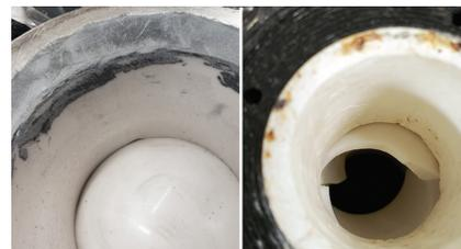
*Las válvulas de bola con revestimiento cerámico existentes estaban teniendo una erosión y fugas significativas de los fluidos agresivos (izquierda) y fallas desde la bola hasta el vástago por la resistencia de las bolas (derecha).*
