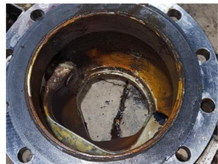
*Después de 6 meses de servicio, la inspección de la válvula S19 de Bray no mostró señales de depósitos de cristales de azúcar, y continuó prestando un servicio sin interrupciones durante 3 temporadas completas de producción.*
