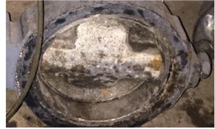
*Las válvulas mariposa instaladas mostraron señales de grandes depósitos de cristales de azúcar, haciéndolas incapaces de operar después de tan solo 15 días de servicio.*
