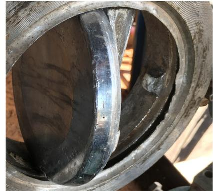
*Las válvulas mariposa instaladas mostraron señales frecuentes de daños causados por el fluido agresivo, requiriendo paradas cada dos semanas para limpiarlas y repararlas.*
