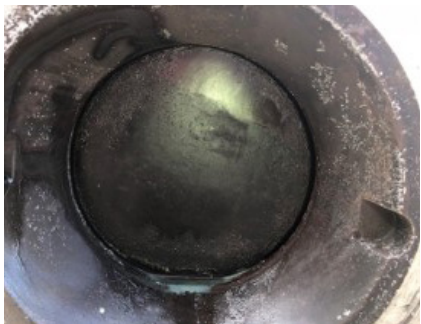
Luego de 18 meses en servicio sin problemas, el diseño de la válvula de bola firme no mostró signos de desgaste ni acumulación de producto upstream.
