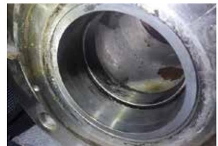
*La inspección reveló restos del fluido, pero la válvula no mostró señales de erosión en el segmento de bola, asiento, paredes del cuerpo o revestimiento.*
