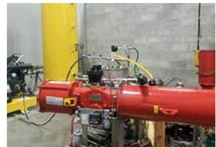
*Prueba donde la válvula McCannalok Serie 42 de Alto Rendimiento y el Actuador Neumático Yugo Escocés Serie 98 lograron más de 1 millón de ciclos con cero fugas*
