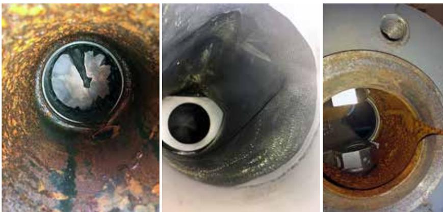
Ejemplos de erosión acelerada en válvulas que requirieron reemplazo
