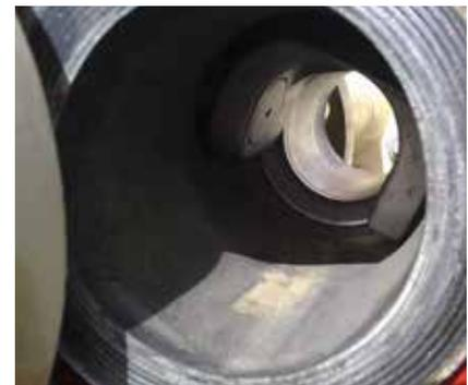
**Las inspecciones mostraron que no había erosión en el revestimiento de la válvula Bray que se estaba probando.**
