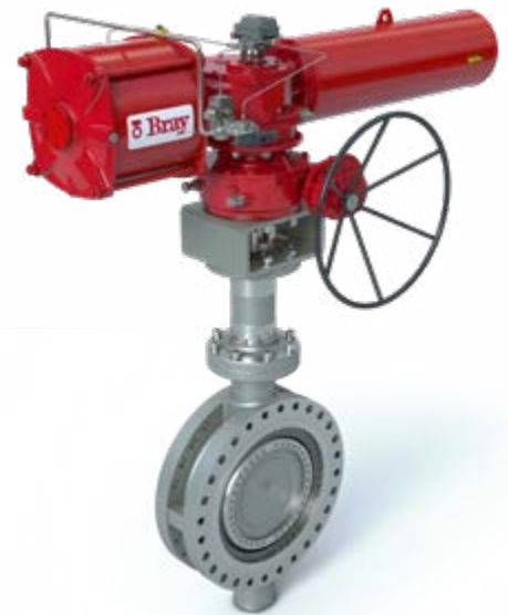
Válvula borboleta triexcêntrica Tri Lok; atuador pneumático Scotch yoke S98; amortecimento hidráulico; volante engrenável.
