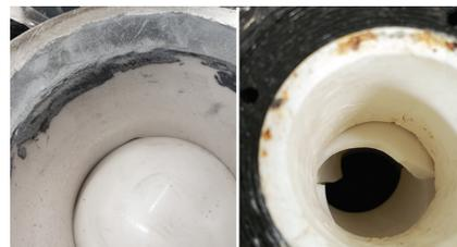
*As válvulas esfera revestidas de cerâmica existentes estavam sofrendo erosão severa e vazamentos dos fluidos agressivos (esquerda) e falhas de esfera para haste de esferas presas (direita).*
