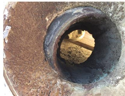
*Após dois meses em serviço, a válvula de um concorrente mostrou sinais de acúmulo severo de fluidos upstream, causando vazamentos frequentes e travamentos.*
