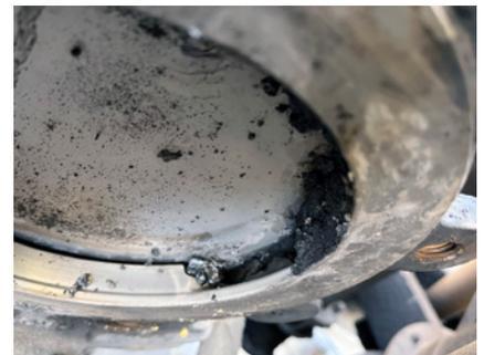
**Diese Bilder zeigen deutliche Anzeichen von Beschädigungen an den vorhandenen einseitig dichtenden Plattenschiebern.**
