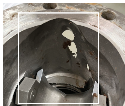
Die Inspektion eines gescheiterten Regelventils eines Wettbewerbers zeigt Anzeichen von umfangreicher Erosion der Gehäusewand, des Segments, des Sitzes und des Flansches.
