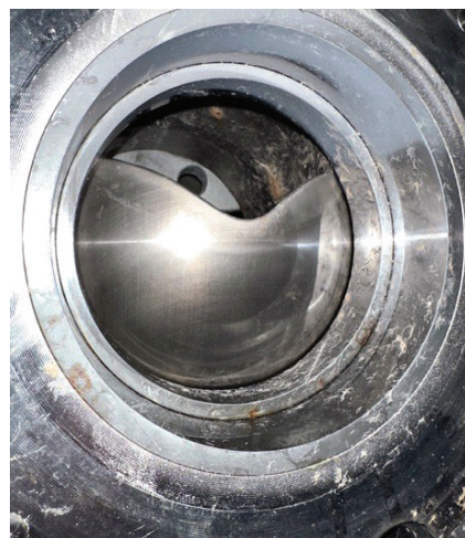
Die Inspektion eines gescheiterten Regelventils eines Wettbewerbers zeigt Anzeichen von umfangreicher Erosion der Gehäusewand, des Segments, des Sitzes und des Flansches.
