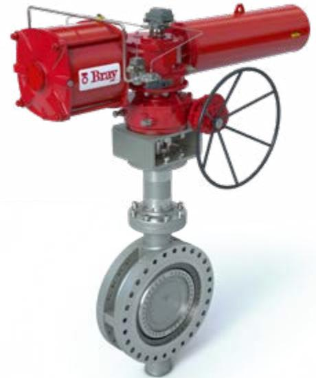
*Vanne papillon Tri Lok à triple excentration; actionneur pneumatique S98 Scotch yoke; amortisseur hydraulique; commande manuelle à débrayage.*
