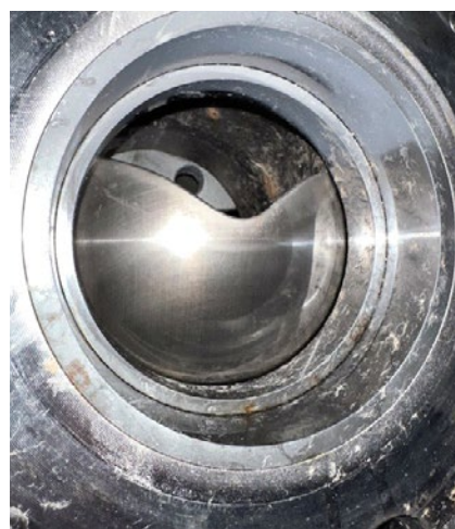
L'inspection d'une vanne de régulation concurrente défaillante révèle une érosion importante de la paroi du corps, du segment, du siège et de la zone de la bride.
