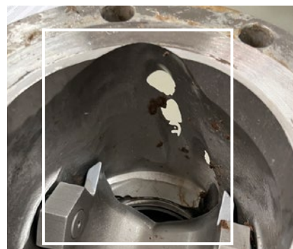
L'inspection d'une vanne de régulation concurrente défaillante révèle une érosion importante de la paroi du corps, du segment, du siège et de la zone de la bride.
