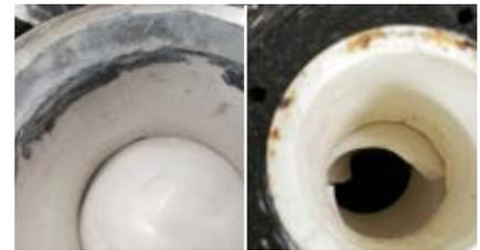
Les robinets à tournant sphérique revêtus de céramique subissaient une érosion et des fuites importantes à cause du fluide abrasif (à gauche) et des dysfonctionnements liés aux boisseaux grippés (à droite).
