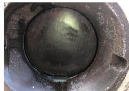
Après 18 mois de service sans problème, la conception du robinet à tournant sphérique résolu n'a montré aucun signe d'usure ou d'accumulation de fluide en amont.
