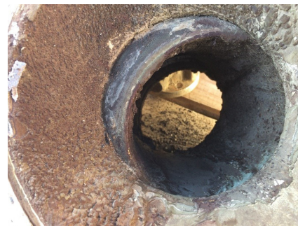
Après deux mois de service, la vanne d'un concurrent présentait des signes d'accumulation de fluide en amont, provoquant des fuites fréquentes et des blocages.
