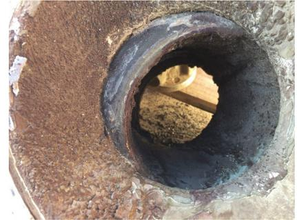
使用2个月后，竞争对手的阀门显示出上游严重介质积聚的迹象——导致频繁的泄漏和锁止。
