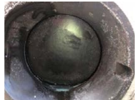
Resolute球阀设计方案在使用18个月没有出现任何问题，没有出现磨损或上游介质积聚的迹象。
