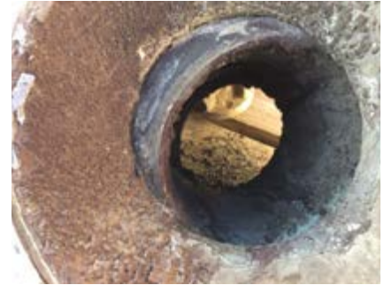
使用2个月后，竞争对手的阀门显示出上游严重介质积聚的迹象——导致频繁的泄漏和卡死。
