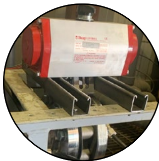
Válvula borboleta Bray submetida a teste de um milhão de ciclos nas instalações do cliente.
