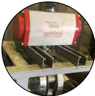
Válvula mariposa Bray sometida a pruebas de 1 millón de ciclos en la ubicación del cliente.
